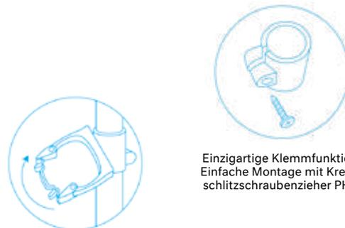
Einzigartige Klemmfunktion. Einfache Montage mit Kreuzschlitzschraubenzieher PH2.
