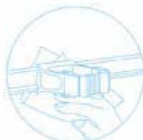
Keine Schmutzstreifen an den Wänden, da die Schiene mit Distanzhaltern versehen ist.
