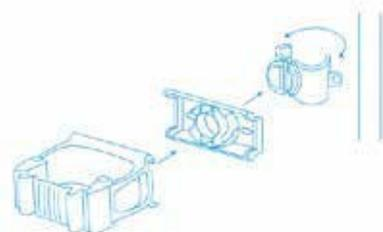
Montage von One Motion wird mit Toolflex One, Adapter und Rohrschelle gemacht.
